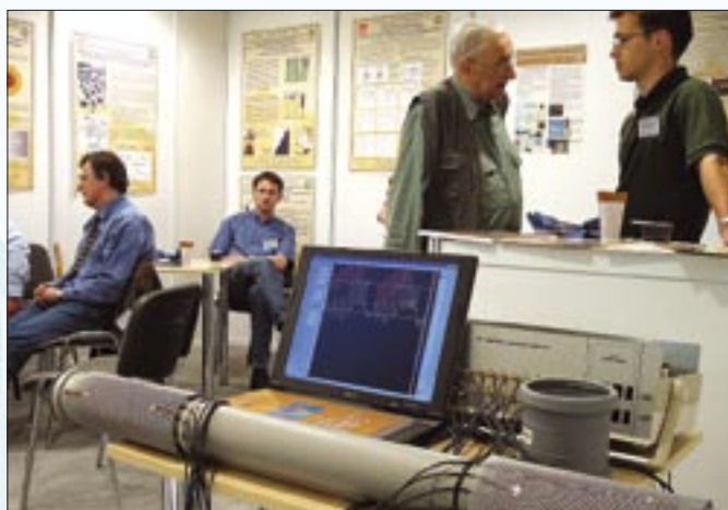
Naukowcy z Politechniki Warszawskiej skonstruowali tomograf pojemnościowy, który pozwala obserwować np. ruch cieczy w rurze
